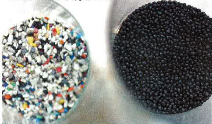
Polystyreen maalgoed verkregen uit kleine huishoudelijke of ICT-apparatuur (links) en het regranulaat dat eruit voortkomt. Dit laatste is direct inzetbaar voor het produceren van nieuwe kunststof producten
